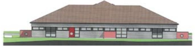
Variante A: Abbruch der Fenster- und Türelemente sowie der Nassgruppen, Sanierung der bestehenden Ziegelwände und Betonflächen, Erneuerung der Holz-Alu-Fenster und Türen sowie der Nassgruppen, Ausrichten der Innenstiegen, Reinigen der Glasoberflächen, Erneuerung der Wege und Traufen Bereiche, barrierefreie Zugänge.
